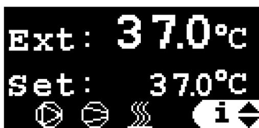
La pantalla principal muestra la temperatura actual en la aplicación externa (Ext) o la temperatura del agua de salida (Out) dependiendo del tipo de control, el punto de consigna actual y muestra qué elementos de la unidad están activos actualmente.
