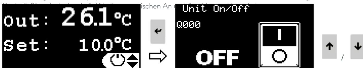
**Temperatureinstellung:** Die gewünschte Auslasstemperatur kann über die Anzeige (entweder über die an das Kühlgerät angeschlossene Fernanzeige oder über den Webserver auf einem Computer) zwischen -10°C (14°F) und 35°C (95°F) eingestellt werden.
