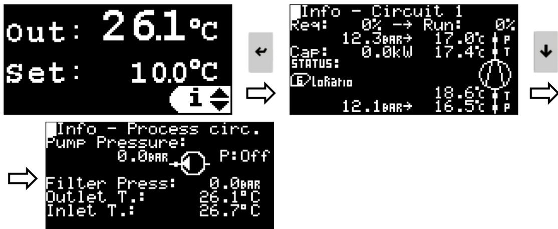
**Regelung und Temperaturstabilität des Kältemittelverdichters:** Das Kühlgerät verlässt sich auf seine Fähigkeit, die Verdichterdrehzahl an die von der Anlage benötigte Kälteleistung anzupassen, um eine hohe Stabilität der Wasserauslasstemperatur zu gewährleisten.
