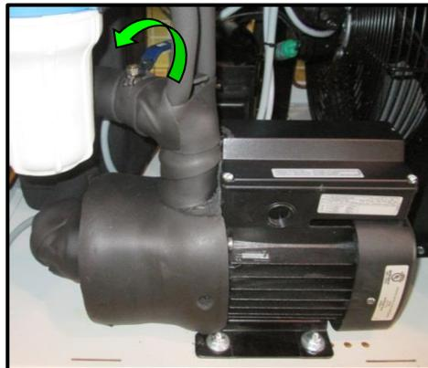
Démarrer l'unité avec le bouton marche/arrêt. Après quelques minutes il est possible que le refroidisseur s'arrête du fait d'une alarme de niveau trop faible (alarme FL), arrêter l'unité et refaire le plein jusqu'au maximum.
