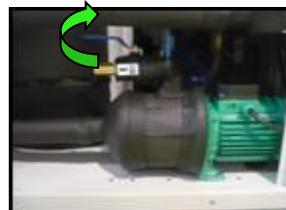
Después de 5 minutos parar la unidad abrir el panel izquierdo y verificar el nivel del depósito. Si el nivel está por debajo del máximo entonces hay que rellenar el depósito de agua otra vez.
