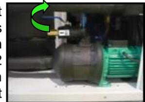
Stoppen Sie das Gerät nach 5 Minuten, öffnen das linke Seitenblech und prüfen den Füllstand im Tank. Ist der Füllstand unter der Höchstmarke, füllen Sie den Tank nach. Wiederholen Sie diesen Vorgang so oft, bis der Füllstand im Tank konstant bleibt.
