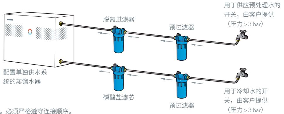
根据原水质量, 可除去单个过滤器元件。必须严格遵守连接顺序。
