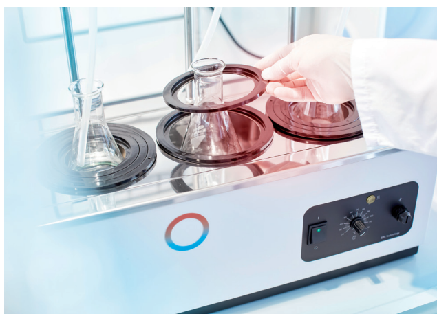
穿孔盖由多组件环套件组成。单套环可拆卸
