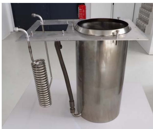
Рисунок 1: Цилиндр нижней части ванны с новым мостом ванны и установленным охлаждающим змеевиком
