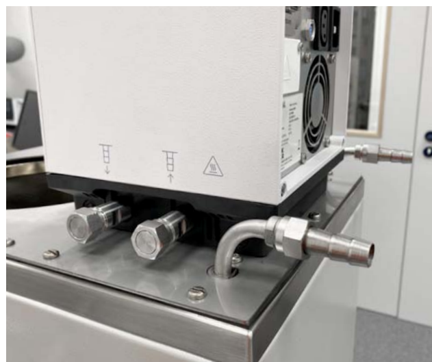
Рисунок 3: Universa MAX, соединенная с нижней частью UB 40 J и разветвленными соединениями охлаждающих змеевиков
