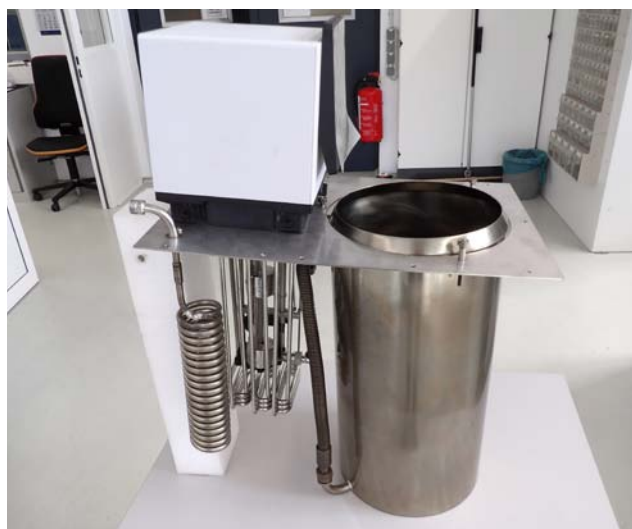
Рисунок 2: Мост для ванны с установленным блоком управления насосом Universa MAX
