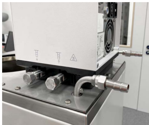
Figura 3: Universa MAX conectada con la parte inferior UB 40 J y conexiones de serpentina de enfriamiento divididas
