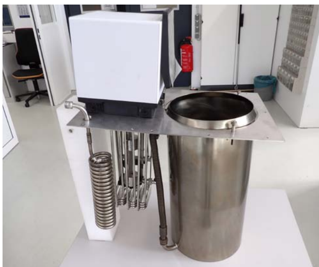
Abbildung 2: Badbrücke mit installierter Universa MAX Pump-Regleinheit
