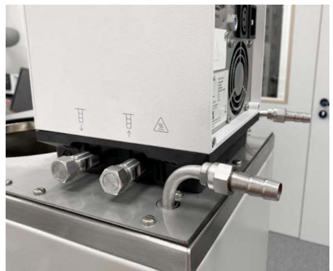
Abbildung 3: Universa MAX verbunden mit dem UB 40 J Unterteil und aufgeteilten Kühlschlangenanlässen
