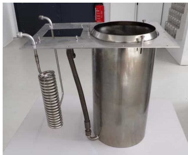
Abbildung 1: Zylinder des Badunterteils mit neuer Badbrücke und installierter Kühlschlange
