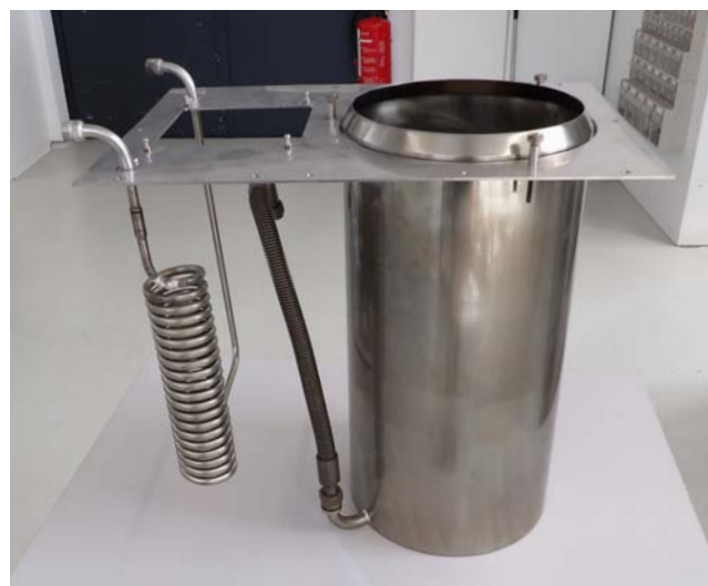
图 1： 浴槽底座圆筒，全新浴槽桥架和已安装的冷却盘管
