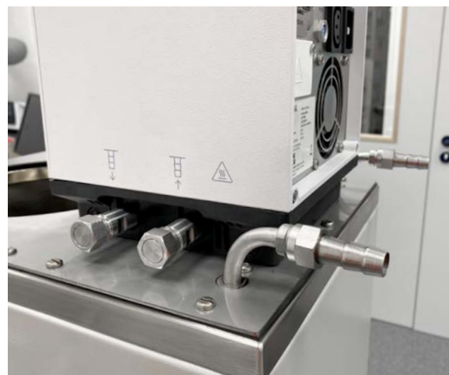
图 3： Universa MAX 与UB 40 J 底座连接，分体式冷却盘管接口可见
