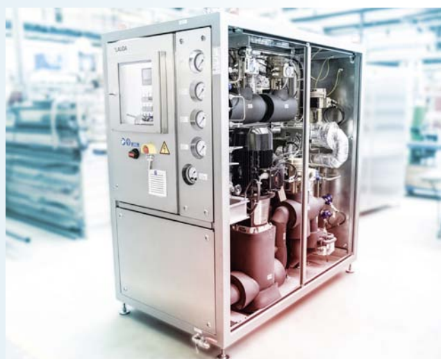
Illustration 1: Un module TR ouvert montrant l'accessibilité
