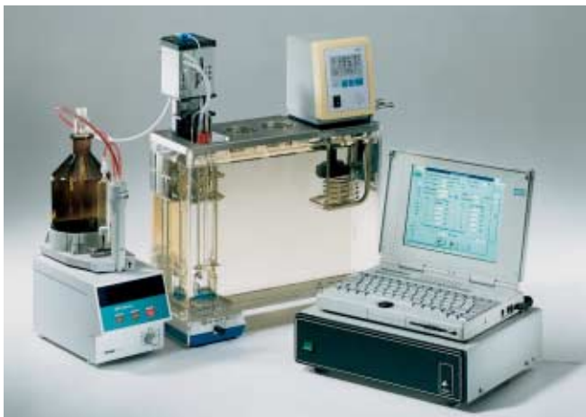
Bild 1. Messplatz mit automatischer Verdünnung zur Bestimmung der intrinsischen Viskosität nach Staudinger
