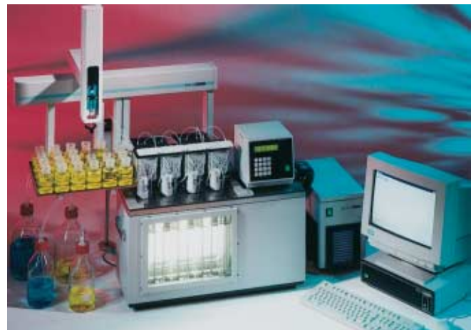
Bild 2. Die Module des Prozessor-Viskositätsmesssystems bieten eine Alternative zur manuellen Messung
