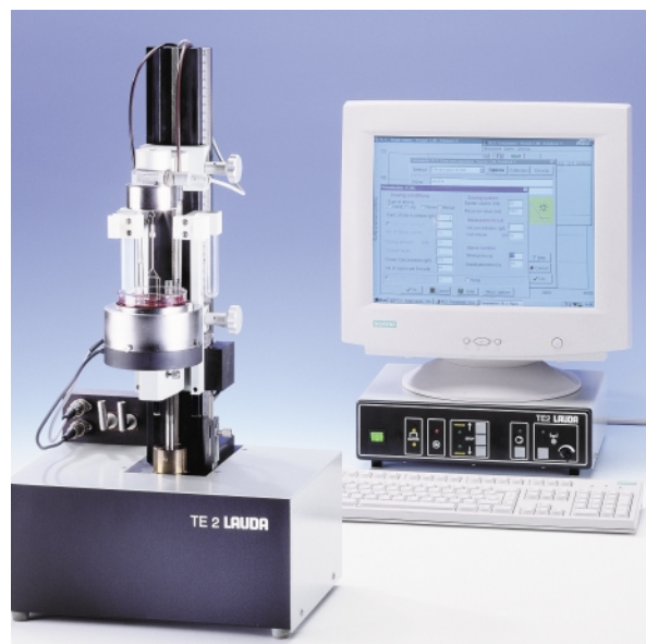
Abb.2: Modernes Ring/ Plattentensimeter mit PC-Steuerung
