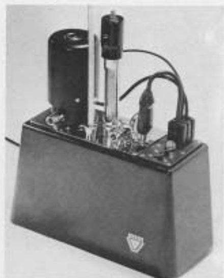
Abb. 15: Haake-Umwälzthermostat FE Die Abbildung wurde von der Fa. Haake Karlsruhe zur Verfügung gestellt
