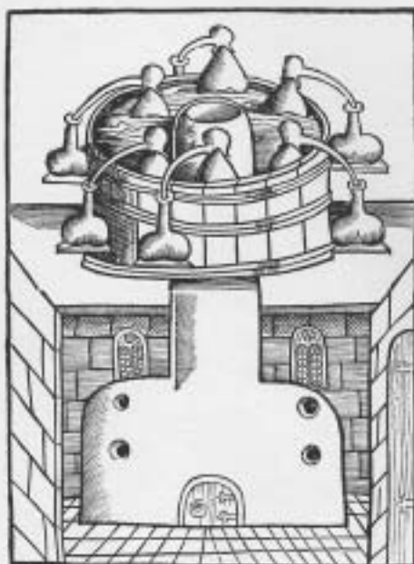
Abb. 1: Destillation auf dem Wasserbad nach BRUNDSCHWIG [2]
