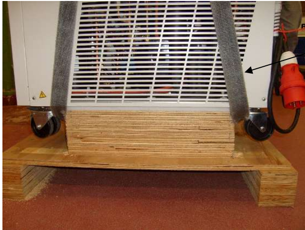
Seitenansicht der Gurtverlegung
