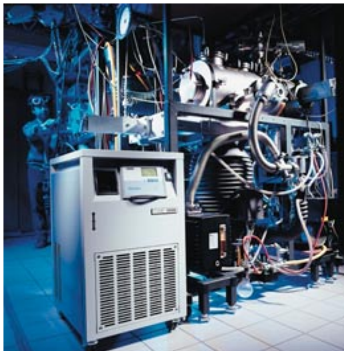
Abb. 1 Temperierung einer Anlage für Materialprüfung mittels Lasertechnik am Physikalischen Institut der Universität Würzburg
