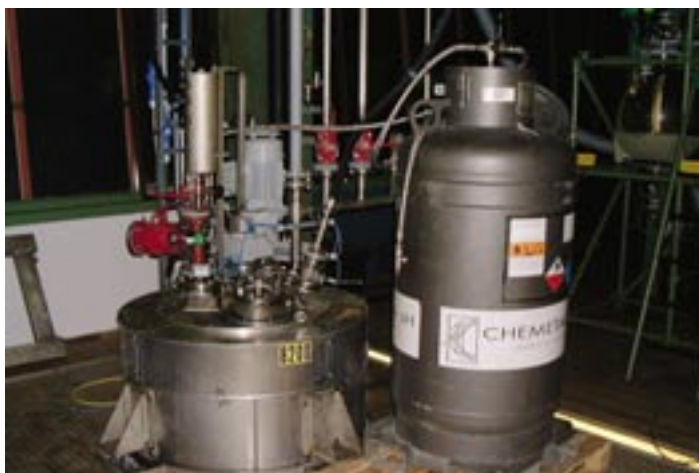
Abb. 2 Das Girindus-Team entwickelte mit dem Rührbehälterhersteller einen besonderen Reaktor: Er ist komplett aus Edelstahl gebaut und auf eine Emaillierung wurde zu Gunsten der besseren Wärmeübertragung verzichtet
