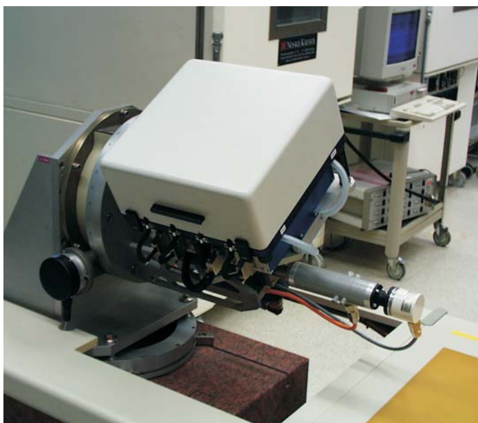
Bild 3: Prüfanlage zum Kalibrieren und zur Abnahme von Kreisel-sensoren mit drei simultan drehenden Kammern. Die erste Kammer ist mit einem Prüfling bestückt. Die zweite ist voll bestückt, die dritte Kammer ist bereits geschlossen. Der Umlaufkühler LAUDA WKL 10000 W übernimmt die Kühlmittelbereitstellung.
