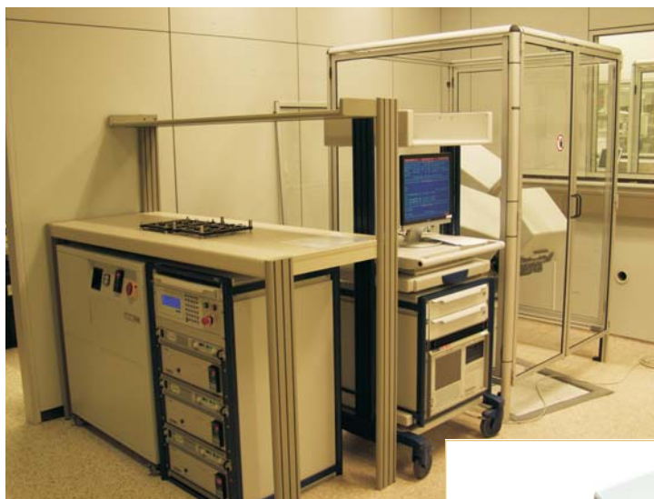
Bild 4: Steuer-schrank mit Reg-eleinheiten für das 3-Kammer-Testsystem (im Hintergrund), links daneben der LAUDA Umlaufkühler WKL 10000 W.
