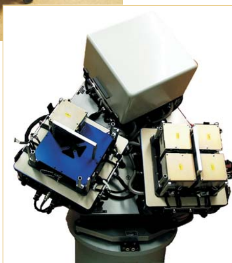
Bild 3: Prüfanlage zum Kalibrieren und zur Abnahme von Kreisel-sensoren mit drei simultan drehenden Kammern. Die erste Kammer ist mit einem Prüfling bestückt. Die zweite ist voll bestückt, die dritte Kammer ist bereits geschlossen. Der Umlaufkühler LAUDA WKL 10000 W übernimmt die Kühlmittelbereitstellung.
