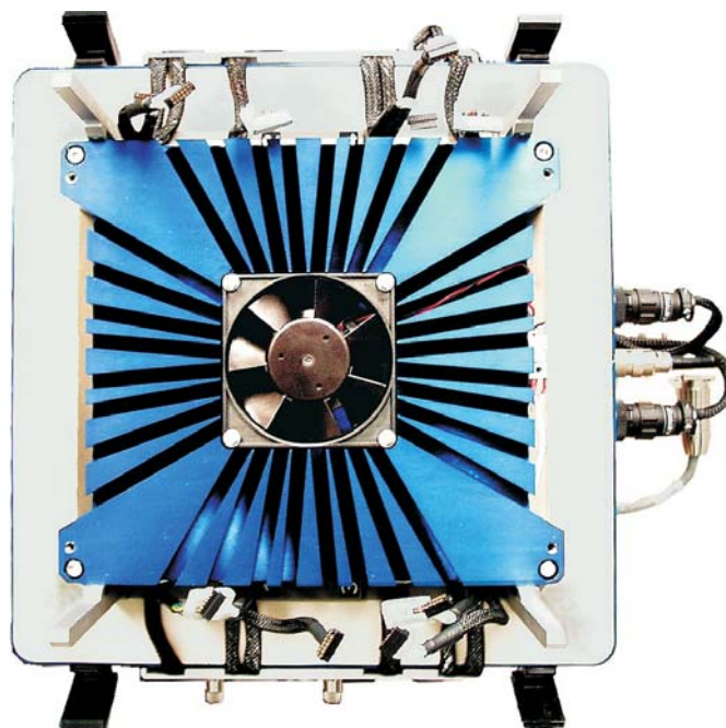
Bild 1: Ventilation und gezielte Luftführung sorgen für homogene Temperaturverteilung im Prüfraum.
