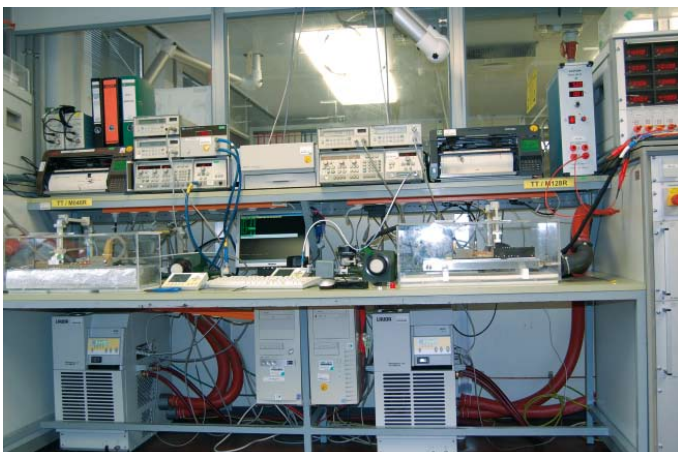
Abb. 3: Parallel-Prüfstand zum Test der thermischen Stabilität von Wanderfeldröhren. Die extremen Prüfbedingungen zwischen -40^{\circ}\text{C} und +90^{\circ}\text{C} erzeugen Lauda Integral XT 250 W Prozessthermostate.
