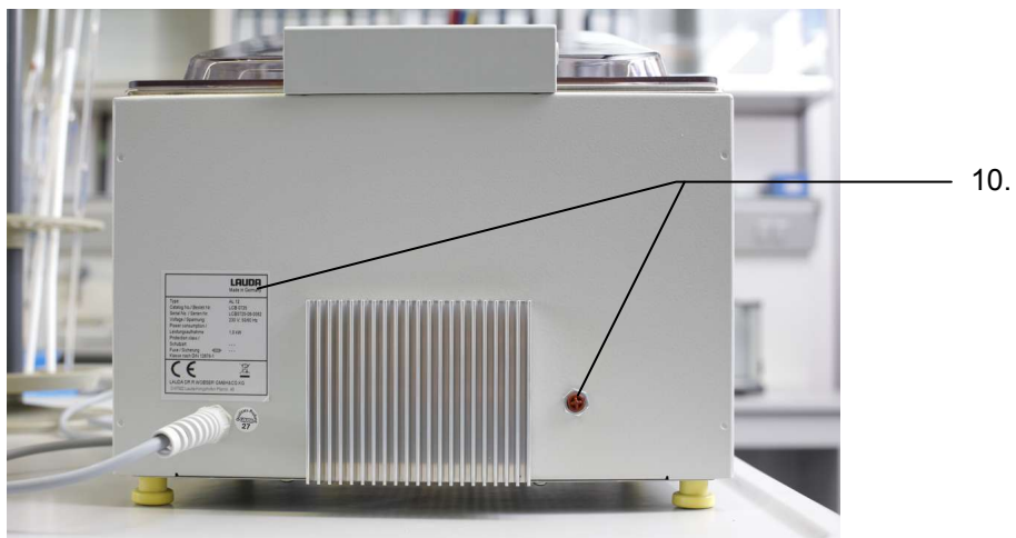
10. Plaque signalétique et touche de réinitialisation du limiteur de surchauffe.
