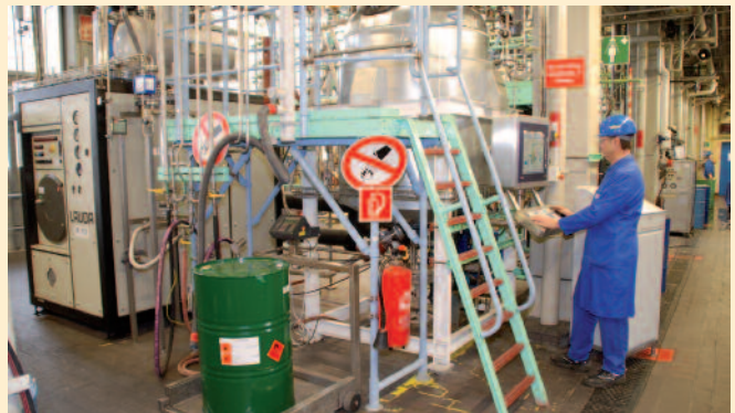
1.000-Liter-Reaktor für Tieftemperatursynthesen bei AllessaSyntec: im Hintergrund das Kryopac-Heiz- und Kühlsystem
