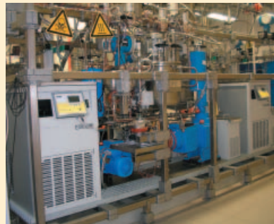
Kombination LAUDA Prozessthermostate Integral T mit LAUDA Kältethermostaten RE 307 für die flexible Kühlung der Polymersuspensionen.
