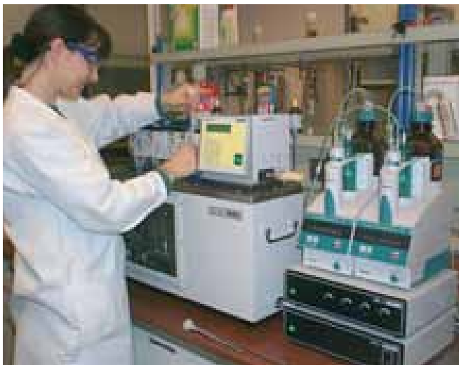
Viskositätsmessung mit dem LAUDA PVS in Durchsichtthermostaten
