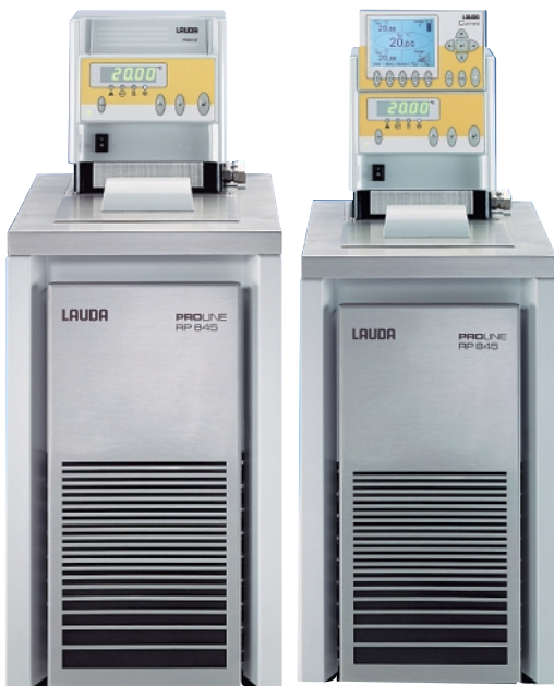
Abb. 5: Lauda Proline Thermostate gibt es als Wärme- oder Kältethermostate in 40 verschiedenen Gerätevarianten. Im Bild sind ein Kältethermostat Proline RP 845 der Version Master (links) und der Version Command (rechts) zu sehen, beide mit 8 l Badvolumen und einer Minimaltemperatur bis zu -45 °C. Die Command Version bietet höheren Bedienkomfort.
