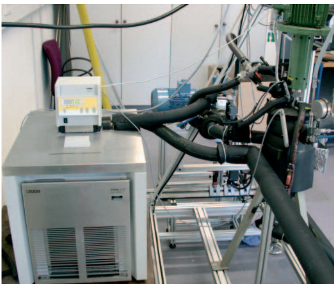
Abb. 2: Anschlüsse des Lauda Proline RP 890 C an das Reaktorsystem
