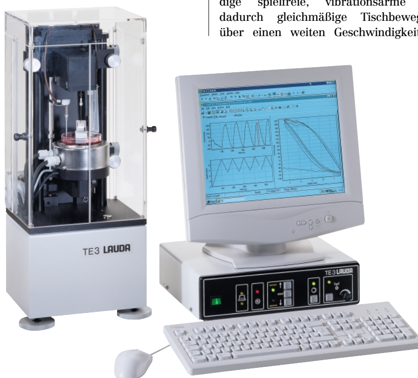
Abb. 2: PC-gesteuertes Tensiometer Lauda TE 3 bei Bestimmung von Kontaktwinkeln an einer PVC-Platte. Der Bildschirm zeigt den Verlauf der Tischbewegung mit der Zeit (links oben), den Verlauf der Kraft über der Messzeit (links unten) sowie die Kontaktwinkelhysteresekurven für mehrere Tauchzyklen (rechts).
